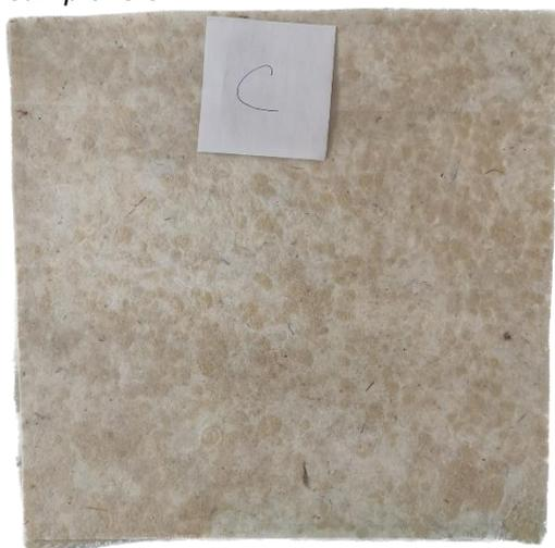
Il campione "C" lo si è formato con le stesse modalità del campione C e con le stesse percentuali in peso delle due componenti fibrose. La lana però non era sottoforma di velo cardato ma di sfere di fibre formate per conferire maggiore isolamento termico e migliore resilienza quando si applicano dei carichi pressori. La macchina utilizzata è visibile nelle immagini a seguire.
