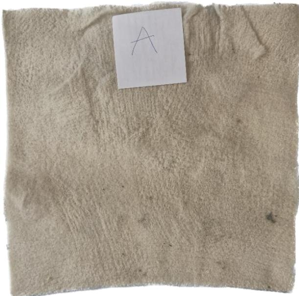
Il campione "A" è stato ottenuto mediante la lavorazione di "agugliatura", un processo meccanico che consiste nel penetrare la massa fibrosa con una piastra di specifici aghi che catturano le fibre legandole fra loro nel movimento ripetuto di entrata ed uscita. Maggiore è la popolazione di aghi ed il numero di battuta, tanto più il TNT risulterà uniforme e compatto.
